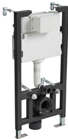
1.0M wall hung WC frame 500(w) x 1000(h) x 167 - 215mm(d) 6/3 litres
